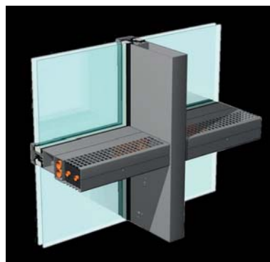
Abb. 32: Isometrie Leitungsführung und Lüftung
