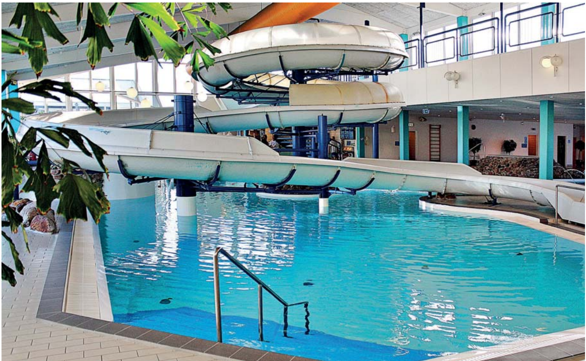
Abb. 36: Rutschbahn innerhalb des Dämmperimeters einplanen
