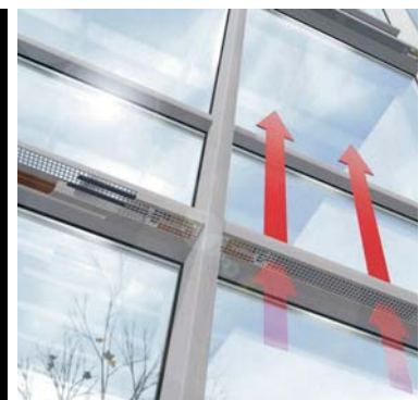
Abb. 33: 3D-Grafik Lufteinströmung bzw. Heizung
